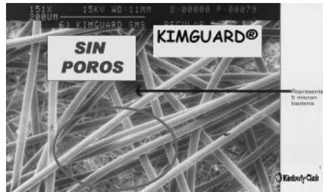
Fig. 4. Tejido Kimguard: la última generación de TST, Polopropileno trilaminado. SMS
